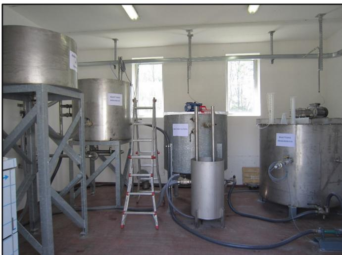
Il progetto ha l'obiettivo di valutare l'efficacia di un trattamento, su refluo civile, con tecnologia innovativa OSA (Oxic Settling Anaerobic) atta alla riduzione della produzione di fanghi di supero.
