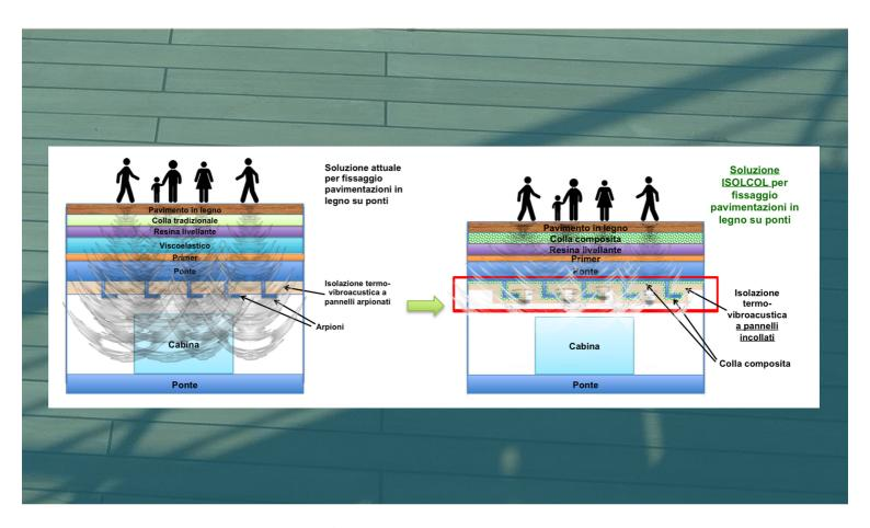
Il progetto ISOLCOL ha come finalità quella di eliminare il viscoelastico mediante la formulazione e la deposizione a spruzzo di una nano-colla includente nano isolanti termo-vibro acustici tra il ponte e la pavimentazione in legno e i pannelli isolanti, che porterà ad un miglioramento dell'isolamento termico e vibo-acustico della cabina, e alla riduzione di spessore, peso, tempi e costi di allestimento.
